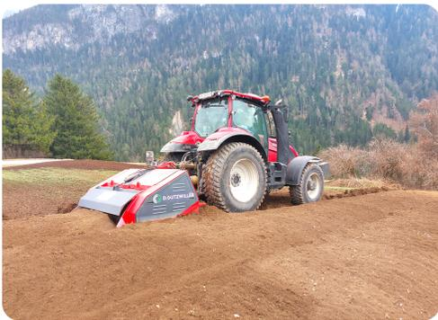
Steinige Äcker? Mühen Sie sich nicht mit dem Steinesammeln ab. Wir zerkleinern die Steine mit unserem Steinbrecher bis zu einer maximalen Kantenlänge von 30 cm.
