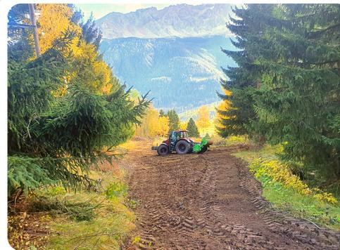
Mit dem Forstmulcher können wir Wurzelstöcke, Äste und Stauden effizient zerkleinern und in den Boden einarbeiten. Sie erhalten eine optimale Saatfläche, da das organische Material, dem Boden als Dünger zur Verfügung steht.
