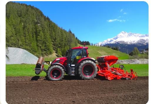
Mit unserer Säkombination der Firma Kuhn können wir in einem Arbeitsgang fräsen und säen. Direktsaaten sind ebenfalls möglich.
