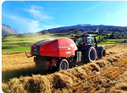
Mit unseren Rundballenkombis der Firma Kuhn können wir auf ein Zugfahrzeug verzichten und befahren Ihre Felder nur mit einer Maschine. Ausserdem ist die Maschine leichter als herkömmliche Kombinationen.
